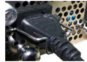
電源線固定座 防止脫落
